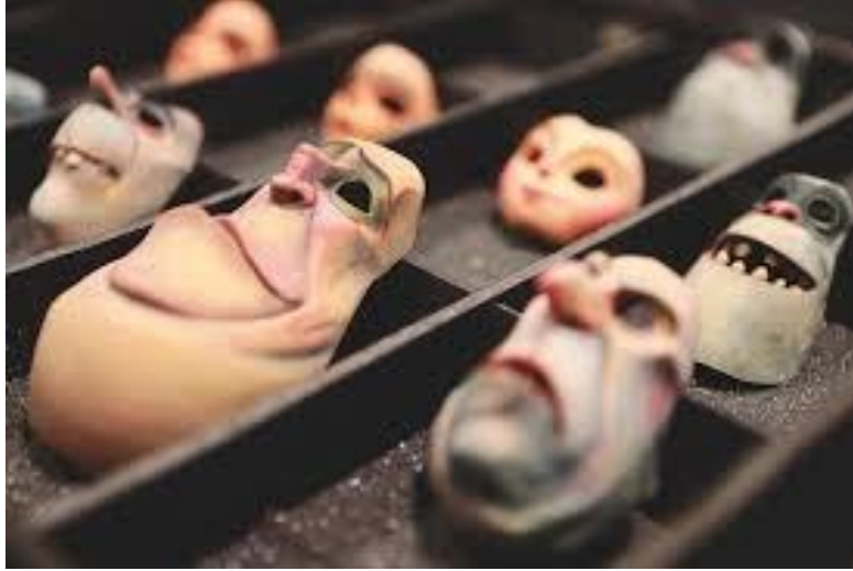
Görsel 2. LAIKA Stüdyosuna ait Kutu Cüceleri (The Boxtrolls) animasyon filmi için 3D print yöntemiyle basılmış yüz modelleri (Davies, 2008).
